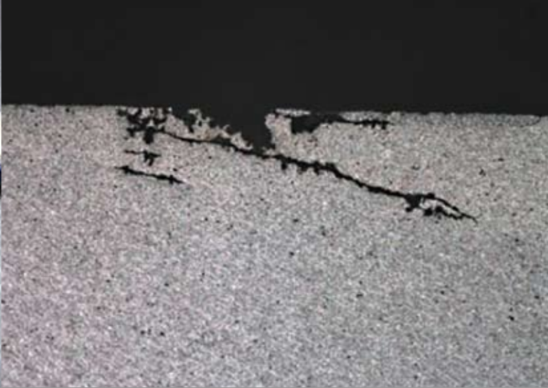
Abb. 2: Interkristalline Korrosion an einer Aluminiumschmiedelegerung (Foto: Institut für Werkstoffkunde (IfW), TU Darmstadt).
