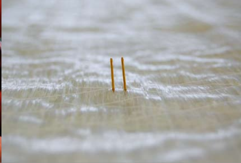
Sensoren werden direkt in die Struktur integriert und können auftretende Schäden überwachen.
