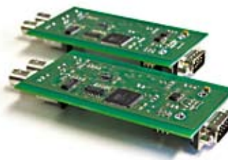
Abb. 4: Die Module Smarter Sensoren ermöglichen eine die Messdaten reduzierende Vorverarbeitung.
