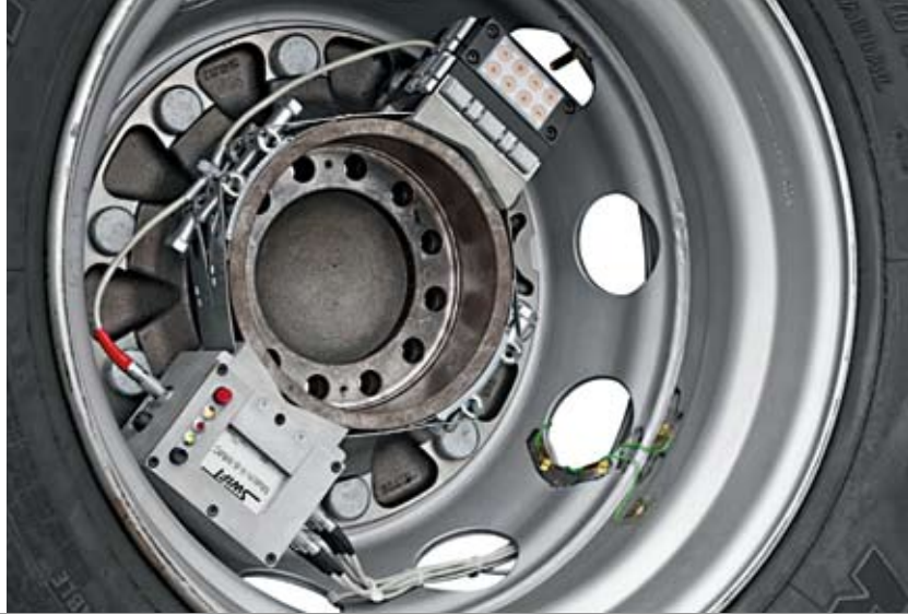
Abb. 2: Messrad zur Kalibrierung der Lkw-ZWARPs direkt beim Prüfstandbetreiber.
