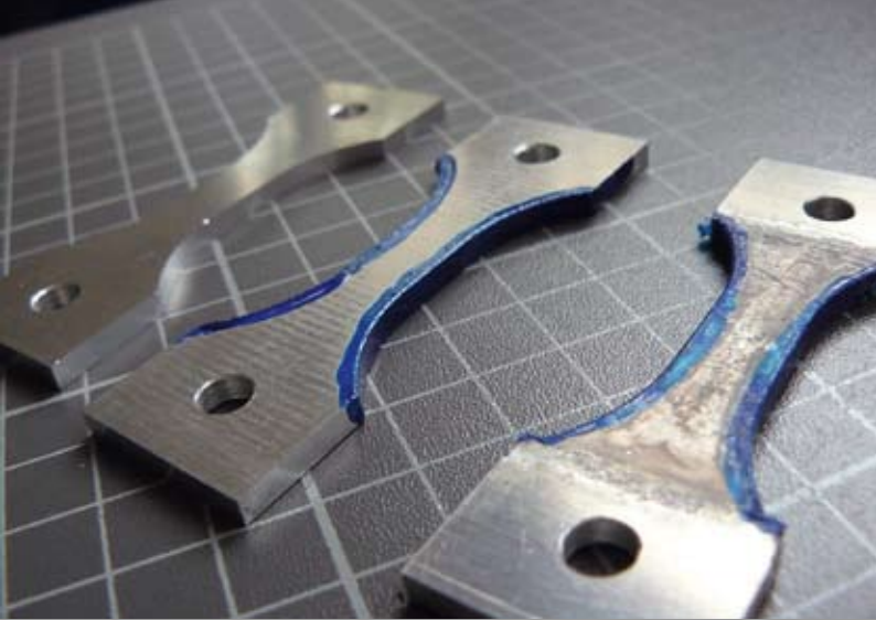
Abb. 1: Die Versuchsproben spiegeln den Ausgangszustand der gewalzten Proben, die geeignete Probenbearbeitung für die Prüfung sowie den Zustand nach Prüfung unter korrosivem Medium wieder.
