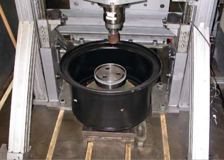
Schlagartige Belastung einer Rad-Nabenbaugruppe im Versuchsstand.
