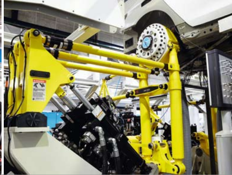
Die Ausstattung mit Messrädern ermöglicht auch eine getrennte Nutzung in Form von zwei 12-Kanal Achsprüfständen.
