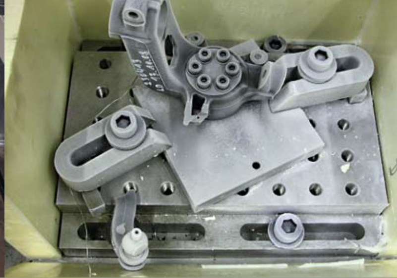
Gebrochenes Pkw Schwenklager nach schlagartiger Belastung unter T = -90^{\circ}\text{C} .
